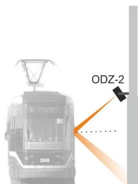
Błędne ustawienie ODZ-2 - odbicie wiązki pomiarowej od szyby tramwaju.
