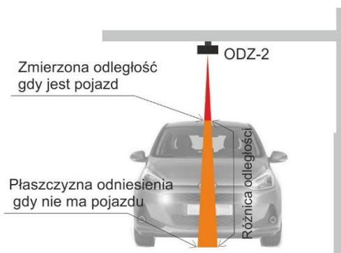
Detekcja różnicowa pojazdu ODZ-2 - możliwe odbicie wiązki pomiarowej od szyby samochodu.
