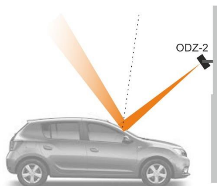
Błędne ustawienie ODZ-2 - możliwe odbicie wiązki pomiarowej od szyby samochodu.
