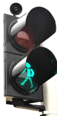
Proponowany sposób montażu głośnika tubowego.
